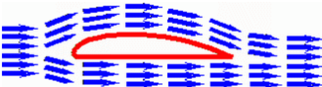
Fig. 3 Illustration commune du flux d'air autour d'une aile. Cette aile ne porte pas (très peu).
