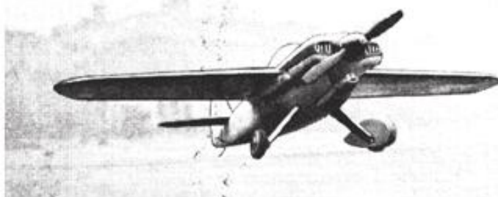
FIG. 49. — Maquette de vol circulaire du SHOESTRING au Concours de Cachan. Le moteur est placé horizontalement. Remarquer le carénage très enveloppant. Au cours d'un atterrissage brutal le carénage d'une roue a été perdu.
