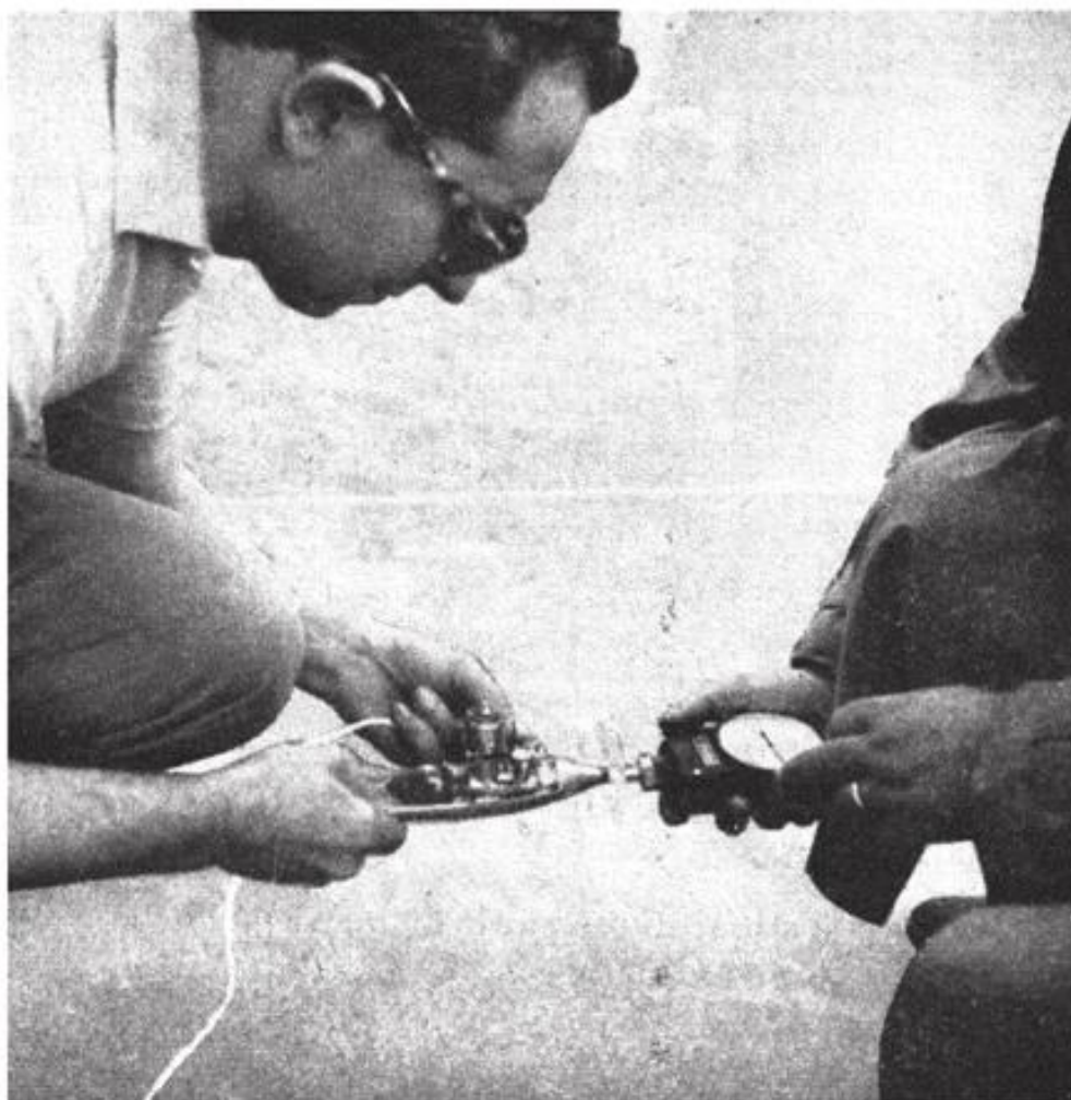
FIG. 65. -- Mesure de la vitesse de rotation d'un moteur « SUPER TIGRE » de 2,5 cm 3 . L'aiguille du tachymètre indique 18.000 tr/mn.
